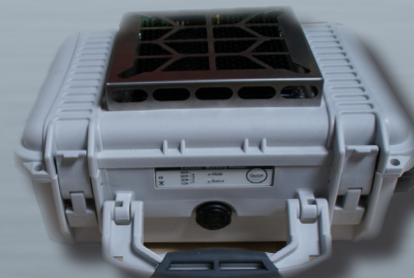
Coffret puissance onduleur 350 W
